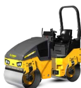
عدد (٦) هراس أسفلت BOMAG BW 120 AD-5 (3 Tons)
