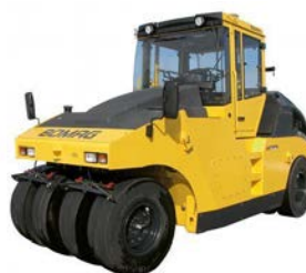
عدد (٦) هراس أسفلت Pneumatic BOMAG BW 24 RH (24 Tons)
