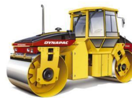
عدد (١) هراس أسفلت DYNAPAC CC 422HF (12 Tons)
