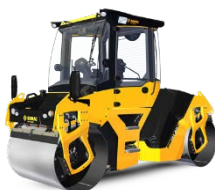
عدد (٣) هراس أسفلت BOMAG BW 202 AD-4 (12 Tons)
